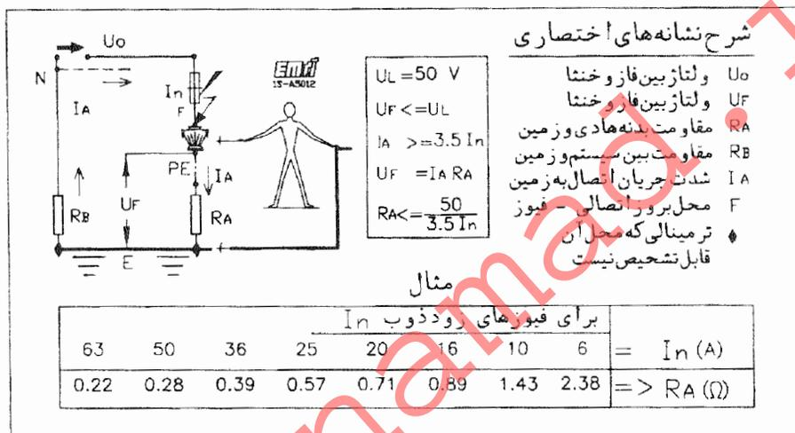
شکل ۳۳۲-۱ هنگام استفاده از فیوز، شرطی که لازم است برای قطع به موقع مدار برقرار شود.
